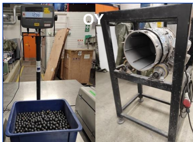
Kuva 2. OSAOn ja Oulun yliopiston Minipilot-laboratorion kuulamyllyt, joita käytettiin betonijauheen jauhatukseen.
