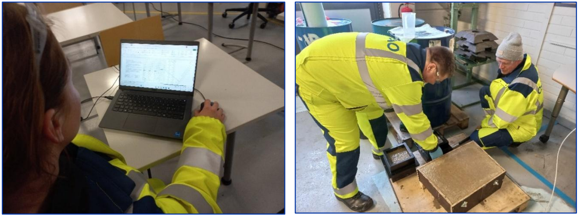
Kuva 16. Betoniseoksen suhteituslaskelmat ja valu puistonpenkkimuotteihin sekä muovisiin lujuusmittausmuotteihin.
