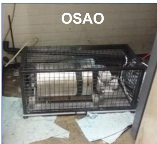
Kuva 2. OSAOn ja Oulun yliopiston Minipilot-laboratorion kuulamyllyt, joita käytettiin betonijauheen jauhatukseen.
