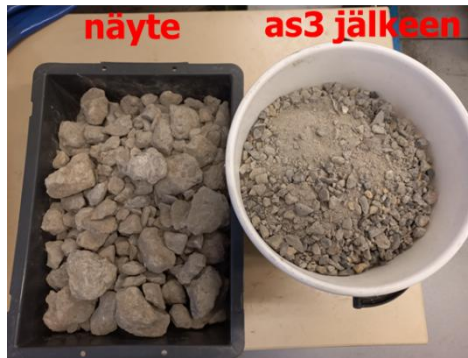
Kuva 4. Vastaanotettua betonimursketta ja mursketta leukamurskaimen jälkeen.
