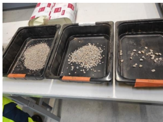
Kuva 10. Hiekka ja sorajakeet seulottuina jakeisiin <125, 125, 250, 500, 1000, 2000, 4000, 8000, 16 000 ja 32 000 μm
