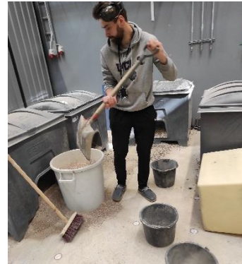
Kuva 9. Testikuutioiden valmistus alkoi ottamalla kolmea erikokoista kiviainesta suhteissa 3:2:3 (0-1, 0-8 ja 0-16 mm)
