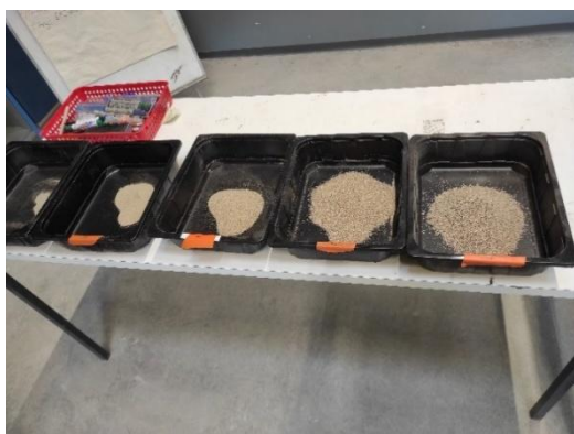
Kuva 10. Hiekka ja sorajakeet seulottuina jakeisiin <125, 125, 250, 500, 1000, 2000, 4000, 8000, 16 000 ja 32 000 μm
