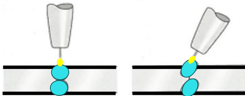
Polttimen virheellinen kohdistaminen vaikuttaa hitsautumissyvyyteen
