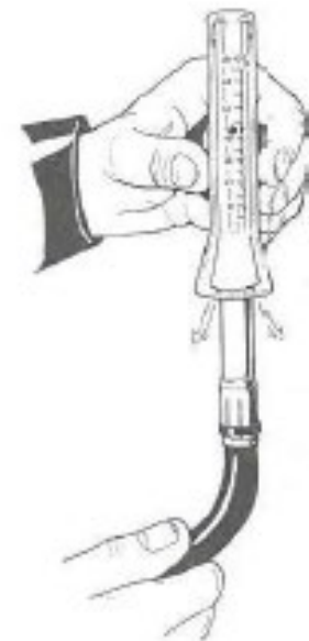
Suojakaasun virtauksen tarkastusmittaus kannattaa tehdä kaasusuuttimen päästä rotametrillä
