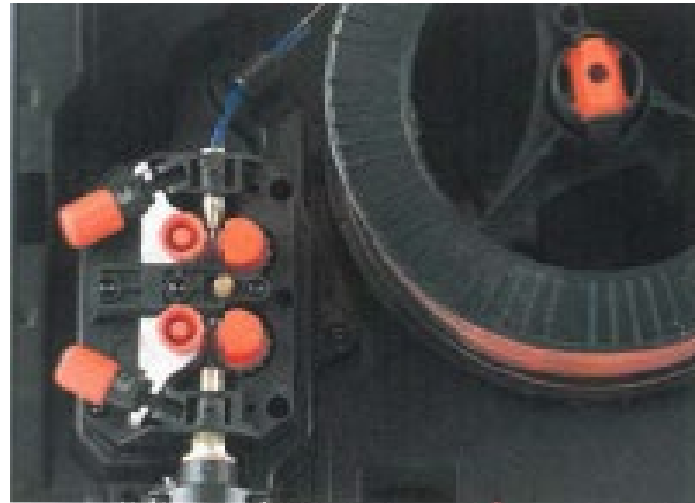
Langansyöttöpyörät paripyörästöllä (teliveto)
