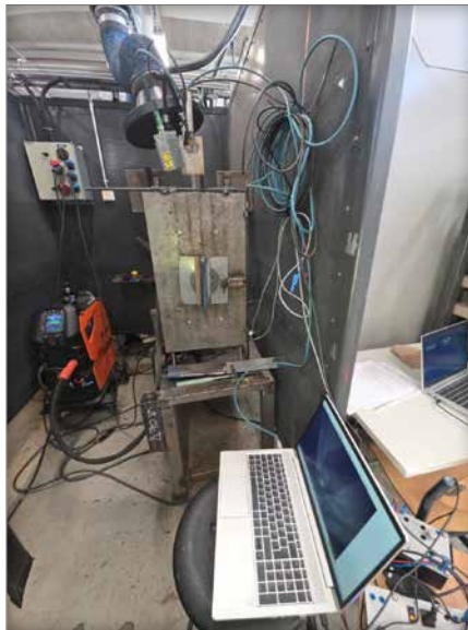
Kuva 3. Tutkimuksessa käytetty hitsausympäristö OSAO:n hitsausloossissa. Kuvassa Kemppi Master M358 -hitsauskone, Cavitar C400H -hitsauskamera sekä potentiometrisäätimet.
